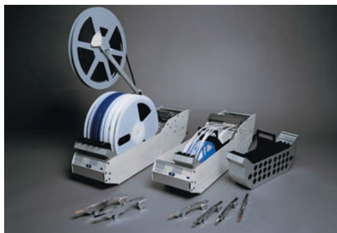
Рис. 2. Дополнительные магазины и питатели для установщика
