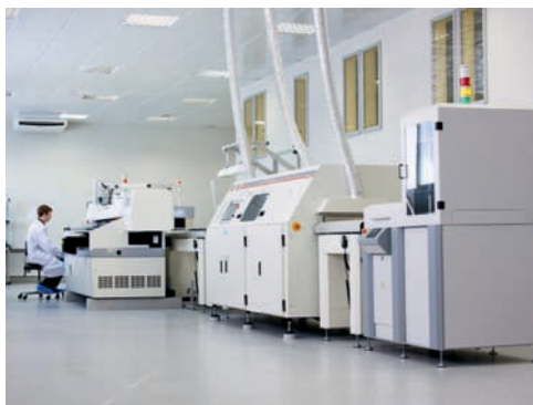
Рис. 1. Первая производственная линия поверхностного монтажа
